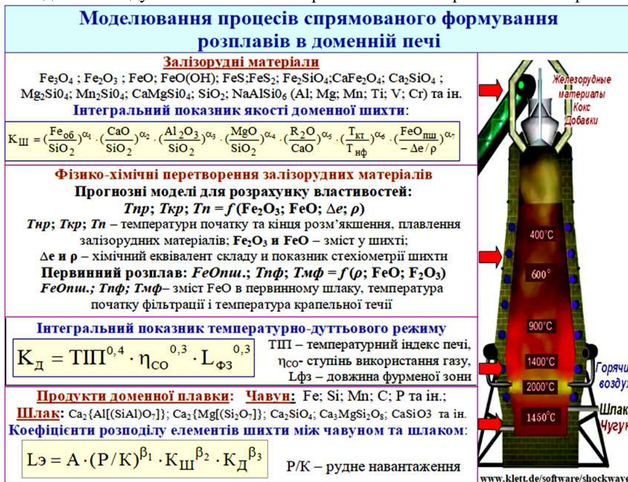
Рисунок 1. Концепція моделювання процесів спрямованого формування розплавів доменної плавки
